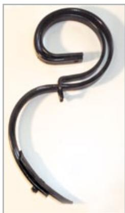
Пружинные зубья с верхней пружиной
