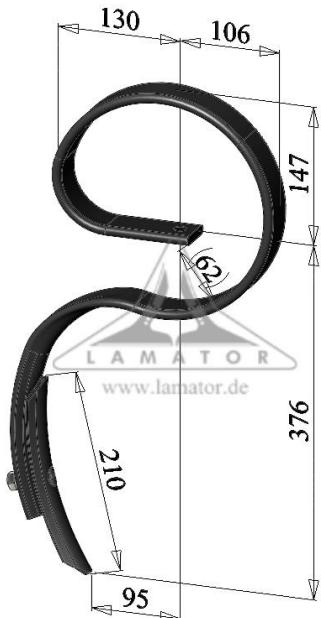
**Federzinken, steil angestellt // Spring Tines, steep angle // Dents de Ressort,
