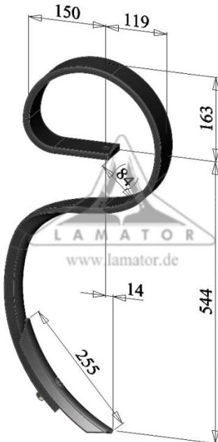
**Federzinken, steil angestellt // Spring Tines, steep angle // Dents de Ressort,
