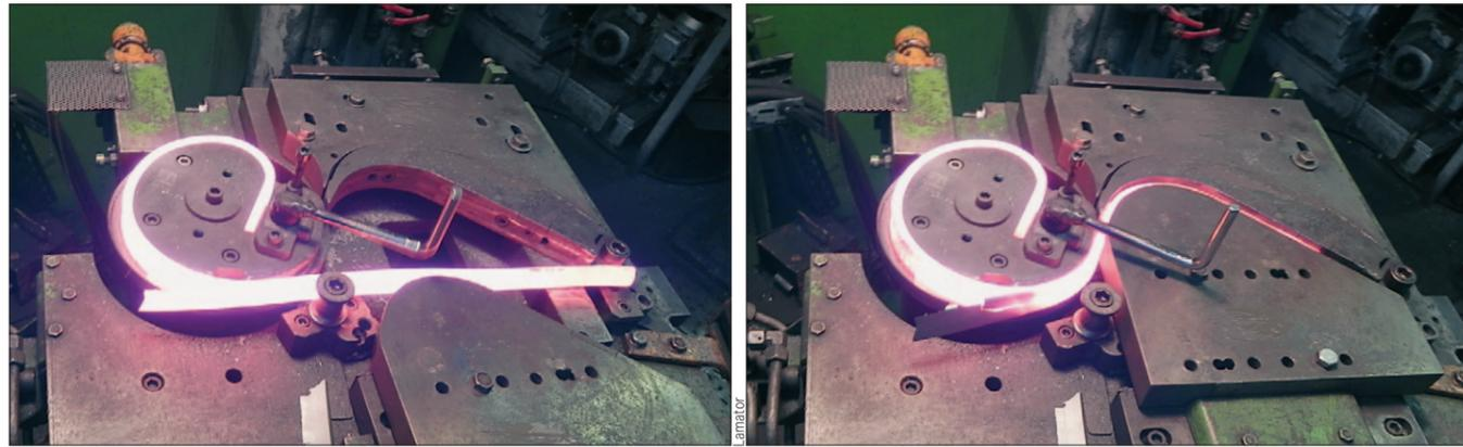
Die Produktion der Optiflex Federzinken im Lamator Werk. Ein besonderes Verfahren staucht den Kopfbereich des Federzinkens.
